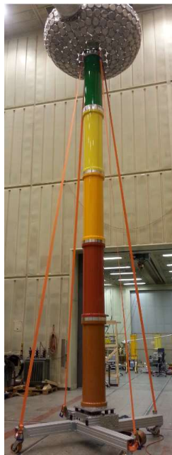
RISE 1000 kV divider
