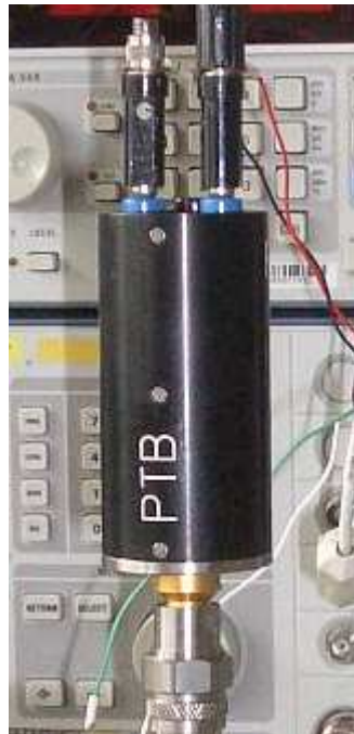
Abbildung 4.1: Thermischer Sensor mit N-Konnektor (PTB-Eigenbau).
