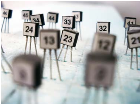
Abbildung 1: geringstmögliches Rauschen durch selektierte Feldeffekttransistoren
