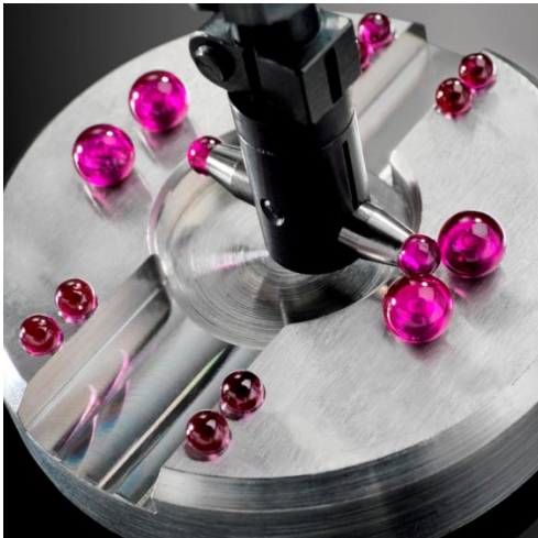
Beispiel eines Lückennormals mit 3 gewählten Kugelquartetten für Gewindesteigungen von 1 bis 6 mm.
