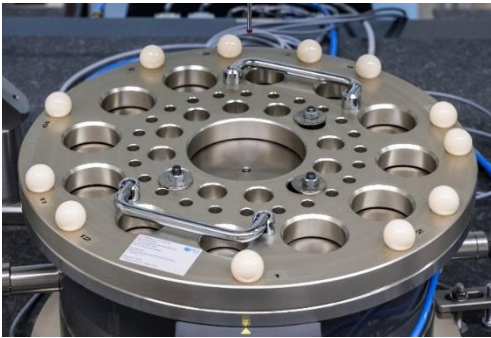
Abb. Neuartiger Kugelteller mit zwölf nicht-äquidistant verteilten Kugeln für die Messung der Drehtischabweichungen in 5°-Schritten
