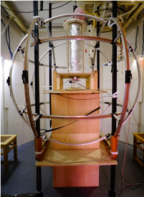
Abb.: Aufbau zur Vermessung der magnetischen Flussdichte eines Feldes im Bereich von wenigen \mu\text{T} innerhalb des Berliner magnetisch geschirmten Raums 2. Hier konnte mit dem neuen Verfahren eine statistische Genauigkeit im Bereich von 10^{-7} erreicht werden.
