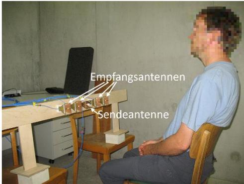
Abb. UWB-Radarkonfiguration mit orthogonal zur Sendeantenne polarisierten Empfangsantennen zur Bewegungsdetektion innerer Organe.
