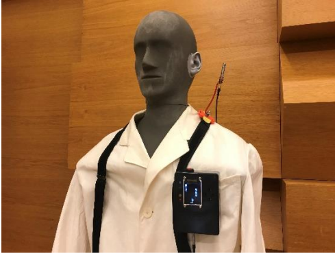
Abb.: Funktionsmuster des Hochfrequenzpersonenschallexposimeters an einem Kunstkopf
