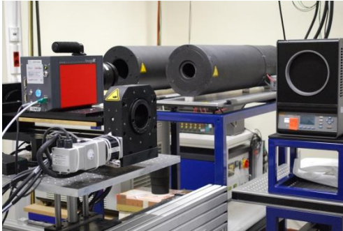
Strahlungsmessplatz der PTB zur Kalibrierung von Temperaturstrahlern und Wärmebildkameras
