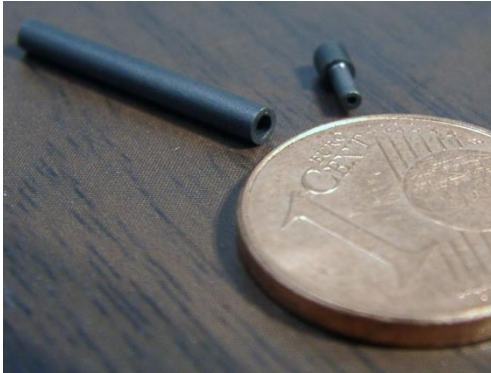
Abb.: Luftgefüllte Ionisationskammern (aktives Volumen: 1 mm 3 ) mit einer 1-Cent-Münze zum Größenvergleich. Derartige Ionisationskammern werden in gepulsten Strahlungsfeldern genutzt und erlauben Einzelpulsdosen von 0,2 mGy mit einer Unsicherheit von 1 % zu bestimmen.
