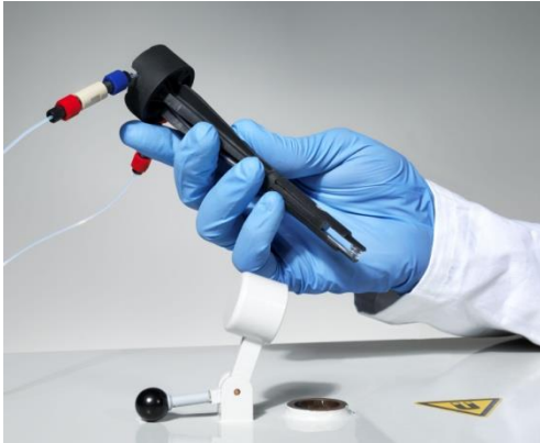
Generativ gefertigte Halterung (schwarz) der Flusskapillare mit spiralförmigem Aufbau beim Einsetzen in das MPS
