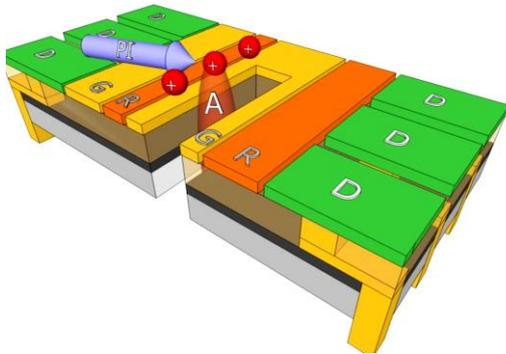
Mehrlagen (Atom) Ionenfalle mit integrierten Durchkontaktierungen und „Ladeloch“, durch das ein Atomstrahl (A) transmittiert wird. Aus diesem können einzelne Ionen von der Rückseite des Chips erzeugt werden.
