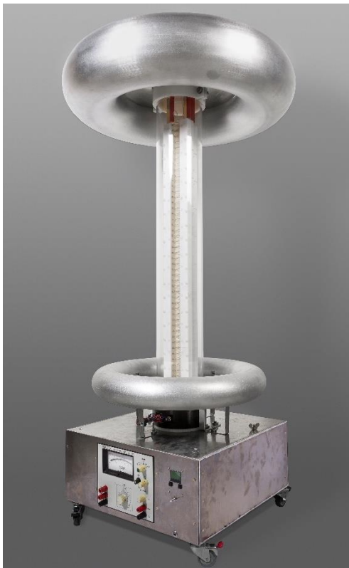
Spannungsteiler: im Plexiglasrohr befinden sich 99 Präzisionswiderstände, die wahlweise in Reihe oder parallel geschaltet werden können
