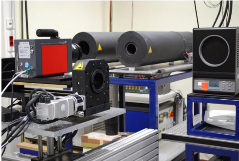
Stahlungsmessplatz der PTB zur Kalibrierung von Temperaturstrahlern und Wärmebildkameras
