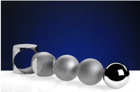
Fertigungskette einer Siliziumkugel; Darstellung der Verfahrensstufen – vom Rohling zur perfekten Sphäre
