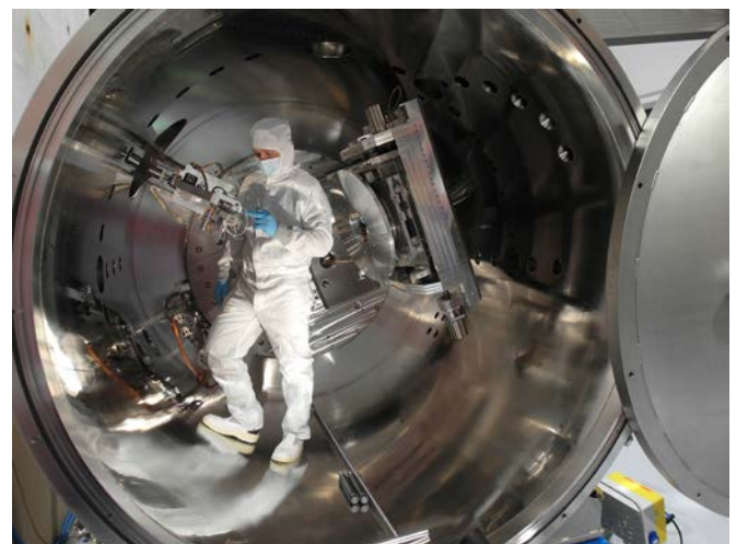
Das Innere des neuen EUV-Reflektometers während der Endmontage
