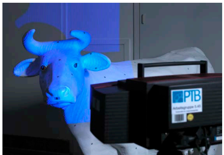
Das mit Messpunkten versehene Kuhmodell wird mit einem Streifenscanner beleuchtet und per digitaler Kamera aus vielen verschiedenen Positionen fotografiert.
