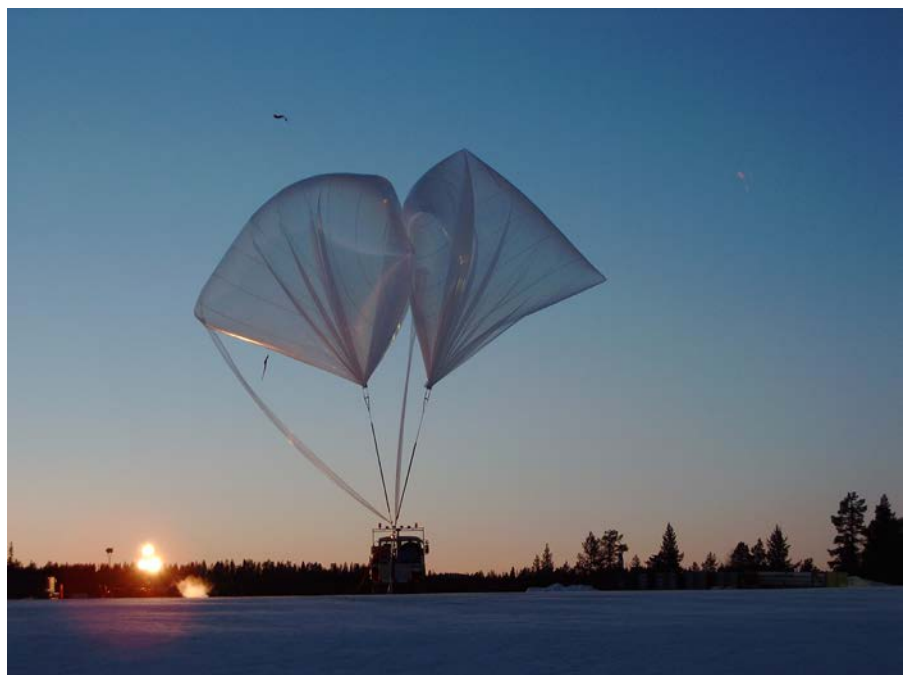
Start eines Stratosphären-Forschungsballoons in Kiruna, Schweden. Mit an Bord: ein Langpfad-Laser-OGS zur kalibrationsfreien Bestimmung von Wasserdampf (und Methan) (Foto: V. Ebert, PTB, 2023)
