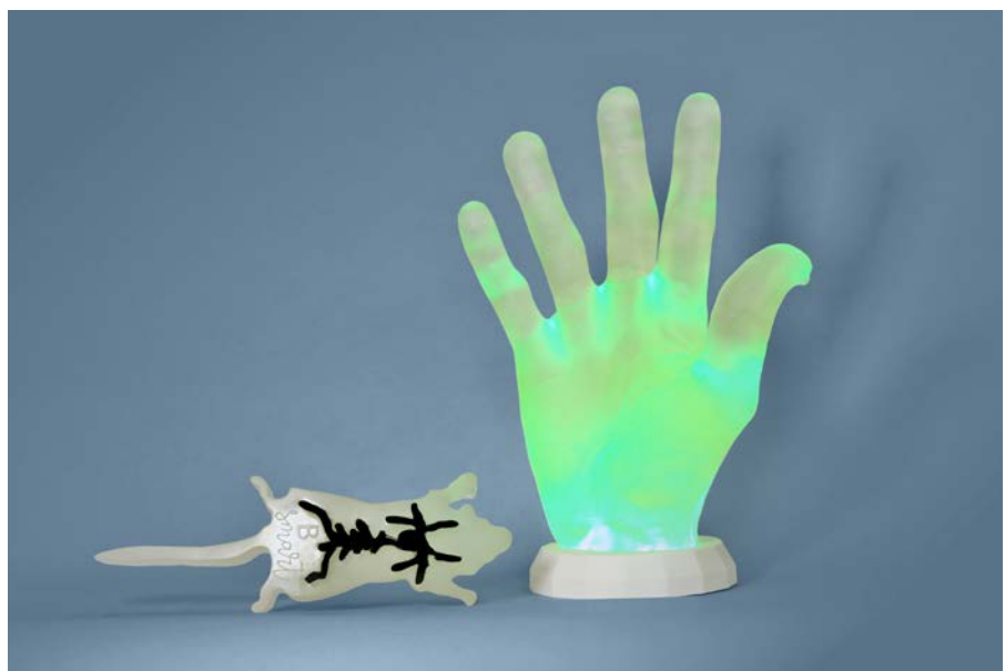
Das Hand-Phantom (rechts) fluoresziert bei Bestrahlung mit Licht einer bestimmten Wellenlänge. Es wird von der PTB für die Weiterentwicklung medizinischer Messverfahren eingesetzt, die mithilfe solcher Fluoreszenzen etwa Rheumaherde aufdecken helfen. Das Mausphantom mit magnetischem Gefäßsystem (links) hilft Medizinern bei der Planung von Experimenten in der Magnetpartikelbildgebung.
