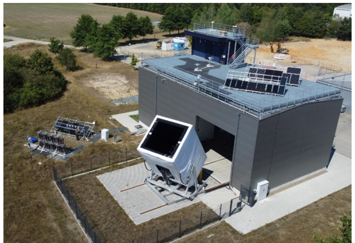
Mit der Frontseite zur Sonne hin ausgerichteter Solarmodultubus während einer Messung
