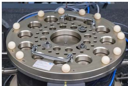
Neuartiger Kugelteller mit zwölf nicht-äquidistant verteilten Kugeln für die Messung der Drehtischabweichungen in 5°-Schritten
