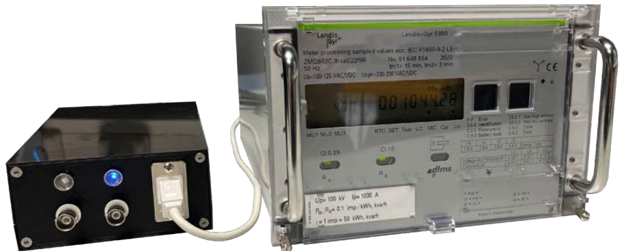
Neu entwickelter SV-Generator der PTB (links) und ein über Ethernetkabel angeschlossener kommerzieller Energiezähler (rechts)
