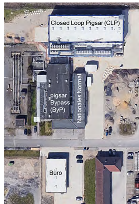
Pigsar-Gelände mit dem Closed Loop und der Bypass-Anlage. Neben der Bypass-Anlage befindet sich das nationale Hochdruckprüfnormal. Unten das neue Bürogebäude, in dem Kunden die Kalibriervorgänge ihrer Zähler verfolgen können.
