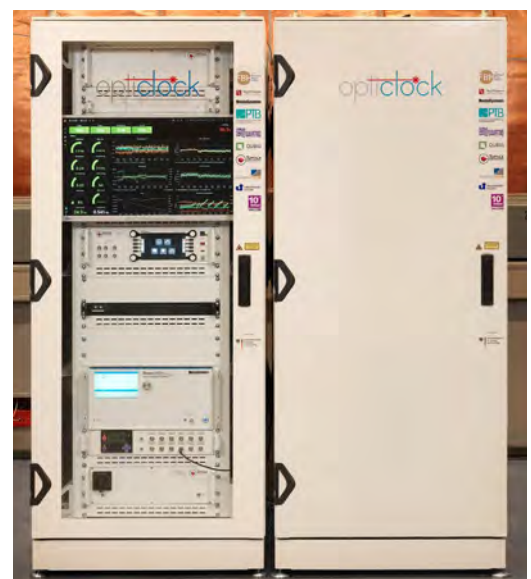
Demonstrator einer optischen Uhr für Anwender. Der linke Schrank beinhaltet Steuerhardware und Elektronik. Im rechten sind alle Laser und optischen Aufbauten, ein Wellenlängenmessgerät und die Ionenfalle untergebracht.
