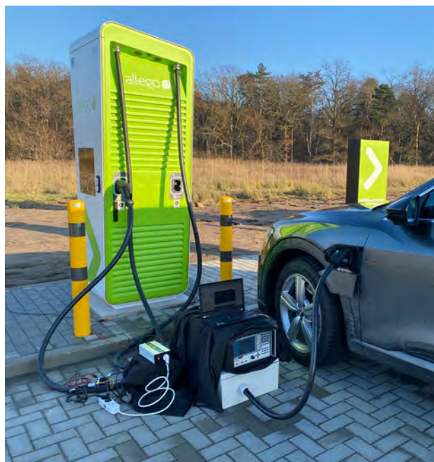
Ladevorgang eines Elektrofahrzeugs an einer Schnellladesäule mit zwischengeschaltetem Messsystem
