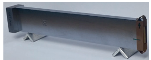
Endmaß aus einkristallinem Silizium mit einer Größe von 197 mm × 35 mm × 9 mm
