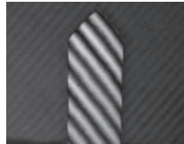
Interferenzstreifen auf einem Cantilever
