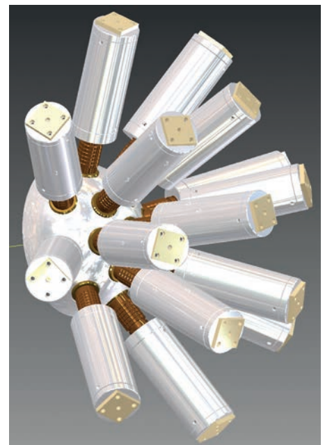
Das neue Gerät besteht aus einer Halbkugel, auf der 15 einzelne Spektrometer angebracht sind, sodass 15 unterschiedliche Raumwinkel zeitgleich gemessen werden können. Damit lässt sich die Haupteinfallrichtung der Röntgenphotonen auf die Person und insbesondere auf die Augenlinse simultan ermitteln, sodass die Zeit für die Charakterisierung des Arbeitsplatzes im laufenden Klinikbetrieb auf das Nötigste beschränkt wird.
