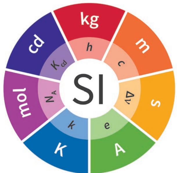
Im neuen Internationalen Einheitensystem (SI) werden sieben Naturkonstanten als definierende Bezugsgrößen festgelegt. Die sieben Basiseinheiten – in der Grafik im äußeren Kreis angeordnet – verlieren ihre herausgehobene Stellung. (Grafik: BIPM)
