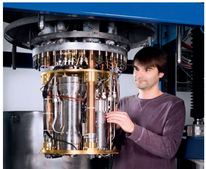
PTB-Wissenschaftler Christof Gaiser mit dem Kern des Dielektrizitätskonstanten-Gasthermometers. Silberfarben: die verschiedenen Druckbehälter mit den speziellen Kondensatoren, die für die Messung in ihrem Inneren mit Helium gefüllt werden.
