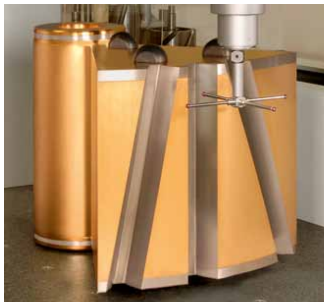
Nur ein Segment – und doch repräsentiert das neue Normal drei unterschiedliche, komplette Zahnräder von je einem Meter Durchmesser.
