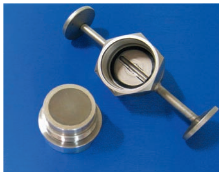
Das in der PTB entwickelte Emanationsgefäß enthält ein elektrolytisch abgeschiedenes Thorium-228-Präparat als Quelle für das benötigte Thoron (Radon-220).
