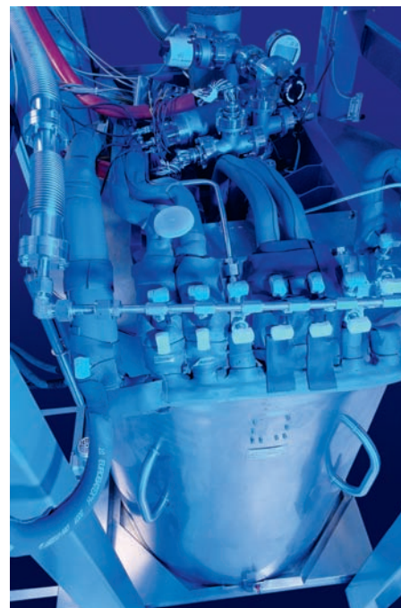
Thermostatenkopf des Dielektrizitätskonstanten-Gasthermometers mit dem Gashandlingssystem, das die Gaszuleitung zu den verschiedenen Messkondensatoren gewährleistet.
