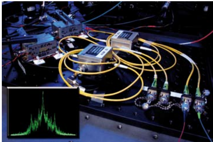
Ein Interferometer mit fasergekoppelten, akustooptischen Modulatoren detektiert Schwankungen der optischen Weglänge in der Übertragungsfaser.
