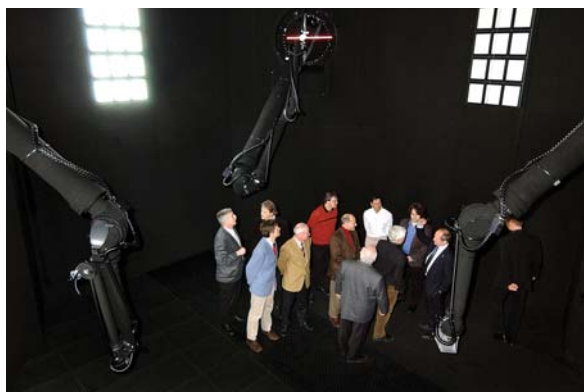
Blick in das Roboter-Goniophotometer mit einem LED-Array als Lichtquelle im Gerätezentrum und den beiden Messrobotern in Grundstellung. Die Personengruppe gibt einen Größenvergleich.
