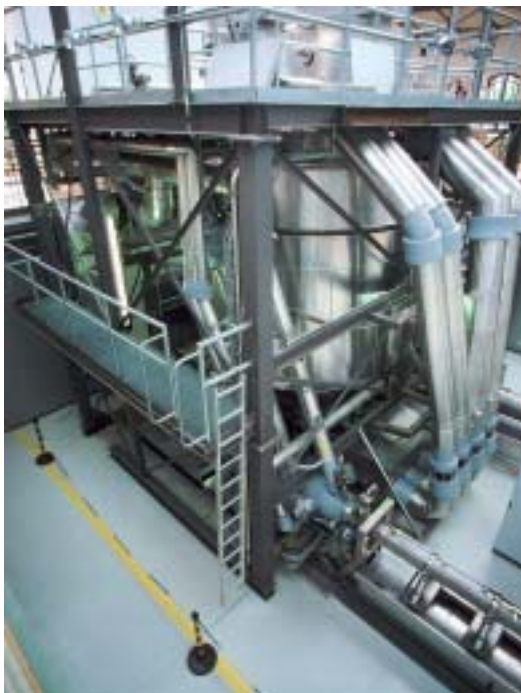
Waage für die gravimetrische Durchflussbestimmung; max. Last: 20 t, Messunsicherheit: 100 g.
