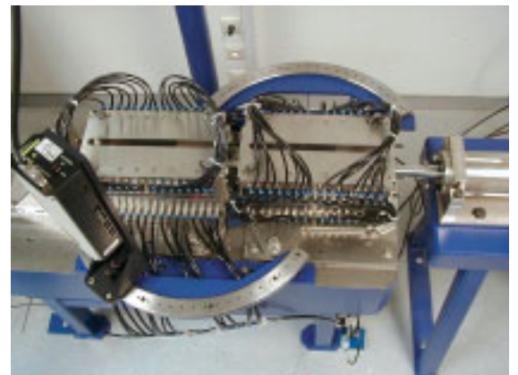
Die neue Kraftstoß-Normal-Messeinrichtung. Zwischen den beiden Massekörpern ist der Kraftaufnehmer angebracht.
