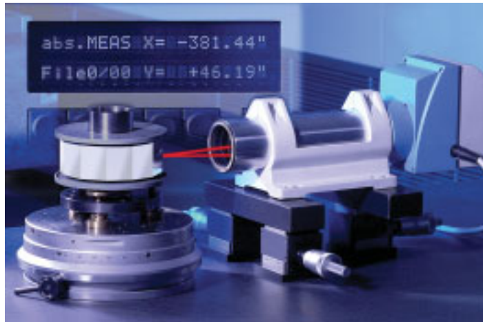
Kalibrierung eines Drehtisches (Indextisch) mit Autokollimator und Spiegelpolygon
