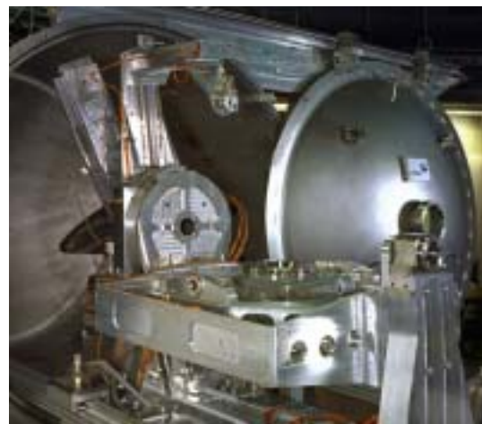
Das neue EUV-Reflektometer. Im Hintergrund die geöffnete Tür des Vakuumschraubs mit 2 m Durchmesser, im Vordergrund auf einem Montagegestell die Mechanik zur Spiegelpositionierung, mit der auch große und schwere Spiegel auf 10 \mu m und 0,01° genau ausgerichtet werden können.
