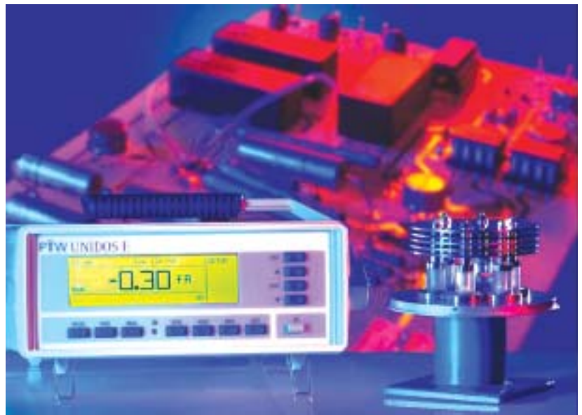
Messgeräte für sehr kleine Stromstärken können mit Hilfe eines Luftkondensators und eines elektronischen Rampengenerators kalibriert werden.
