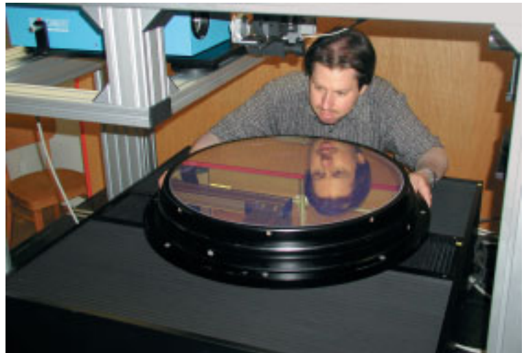
Mit der neuen Apparatur können Prüflinge bis zu einem Durchmesser von 500 mm topographisch ausgemessen werden.
