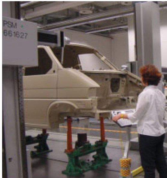
Eine Karosserie auf einem großen Koordinatenmessgerät (Foto: VW)
