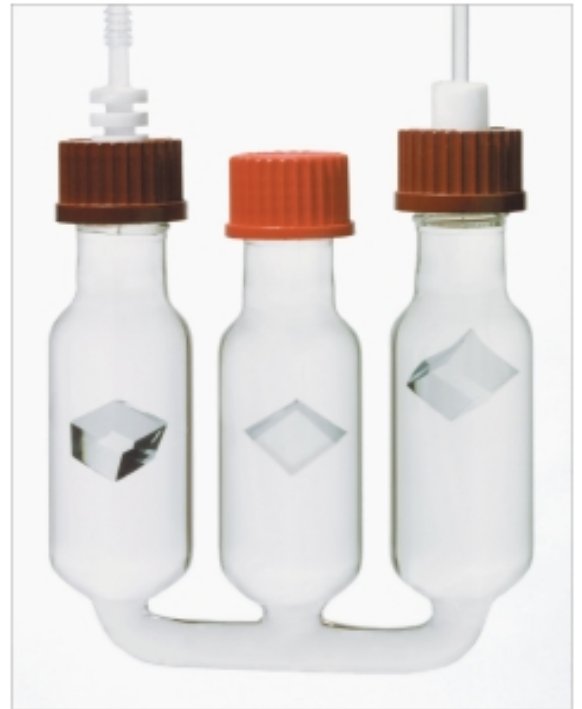
Die Schwebemethode ermöglicht die Messung kleinster Dichteunterschiede von Quarzglasproben. Die Proben haben ein Volumen von ca. 1 \text{ cm}^3 .
