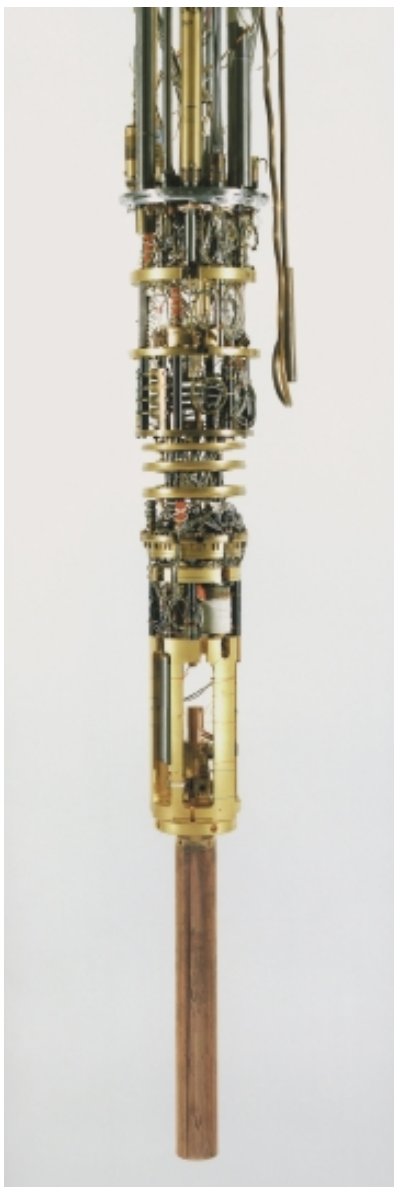
Kryostateinsatz der PTB zur Erzeugung tiefster Temperaturen. Die Kernentmagnetisierungsstufe am unteren Ende besteht aus etwa 2 kg hochreinem Kupfer (magnetische Induktion beim Start 8 T, Endtemperatur 65 \mu\text{K} bzw. 300 \mu\text{K} im Langzeitbetrieb).
