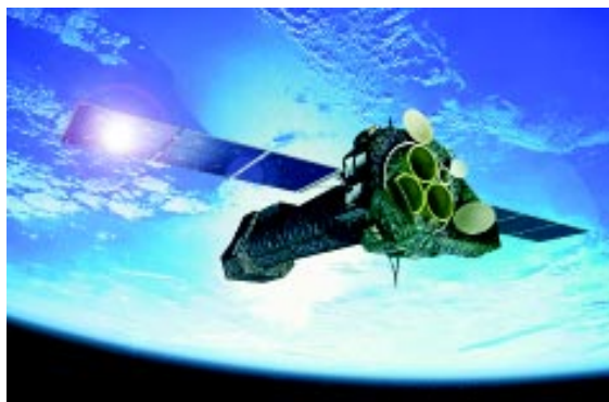
In dieser Darstellung von XMM in der Umlaufbahn sind die Öffnungen der drei Teleskope (vorn) und die Plattform für die Fokalinstrumente (hinten) klar erkennbar. Foto: ESA
