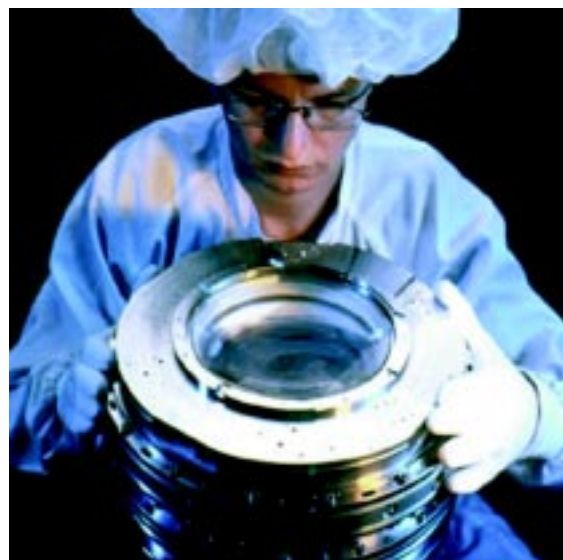
Die präzise Vermessung optischer Oberflächen ist Voraussetzung für die Entwicklung von Lithographieobjektiven, mit denen kleinste Strukturen auf Halbleitern hergestellt werden. Foto: Carl Zeiss
