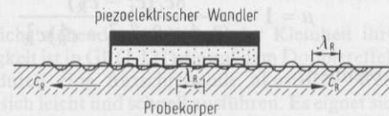
Fig. 1.76 Kammschallkopf für Oberflächenwellen
