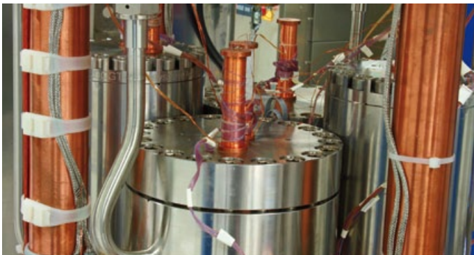
Herzstück des PTB-Gasthermometers zur Neudefinition des Kelvin: Vier Druckzylinder aus Edelstahl nehmen die verschiedenen Kondensatoren zur Messung der Dielektrizitätskonstanten auf.
