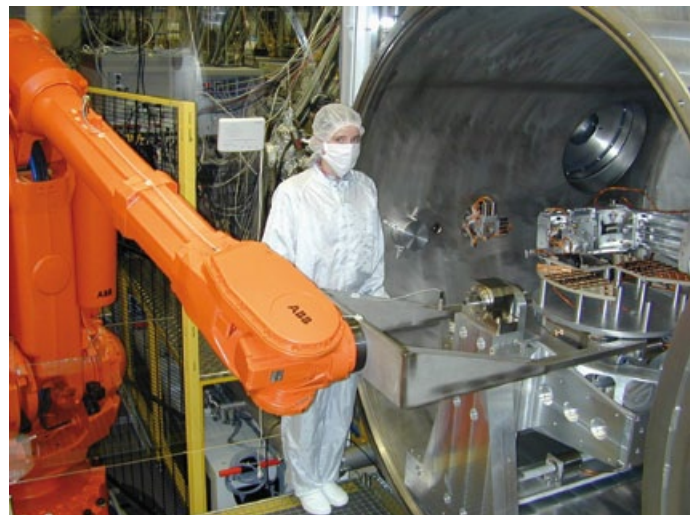
Das EUV-Reflektometer erlaubt die Charakterisierung von optischen Komponenten mit einer Masse von bis zu 50 kg und Durchmessern von bis zu 65 cm.
