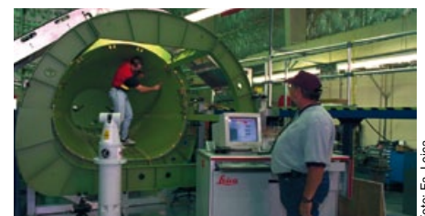
Große Messbereiche flexibel erfassen: Theodoliten-system (vorne links) im Einsatz bei dimensionellen Messungen an einem Flugzeugbauteil.
