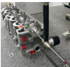
Koordinatenmessgeräte (KMG) sind wichtige Hilfsmittel in der industriellen Messtechnik. Hier wird ein KMG beim Kalibrieren eines Motorblocks gezeigt, der als werkstückähnliches Kalibrier-normal im Deutschen Kalibrierdienst (DKD) verwendet wird.
