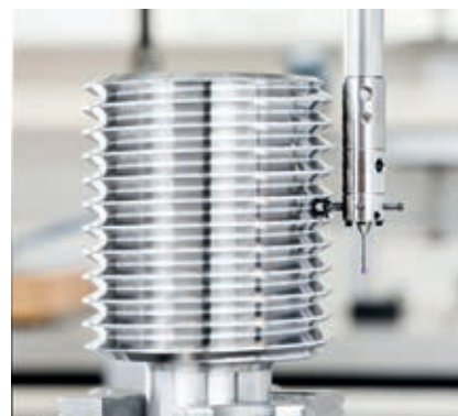
Antastung eines Gewindelehrdorns, aufgespannt auf dem integrierten Drehtisch eines Koordinatenmessgerätes
