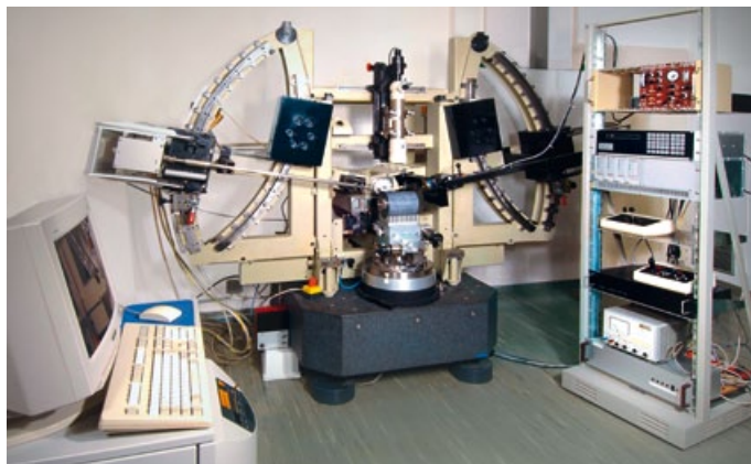
Orientierungsapparatur für einkristalline Werkstoffe. Das Gerät ist etwa zwei Meter hoch und wiegt rund zwei Tonnen.
