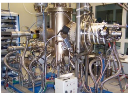
l.: Molekularstrahl-epitaxie-Anlage zur Herstellung von Halbleiter-Quantennormalen wie Quanten-Hall-Widerständen.
