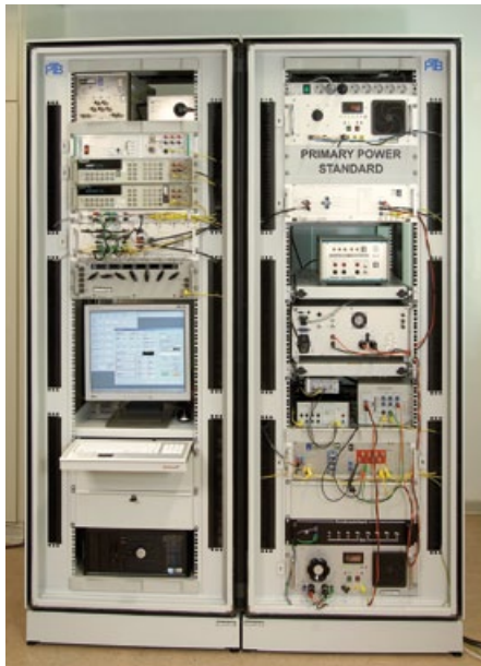
Das Primärnormal der PTB für die elektrische Leistung.
