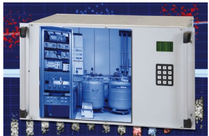
Kryostromkomparator-Messtechnik zum Vergleich von Gleichstrom-Widerständen für den Aufbau der Ohm-Skala.
