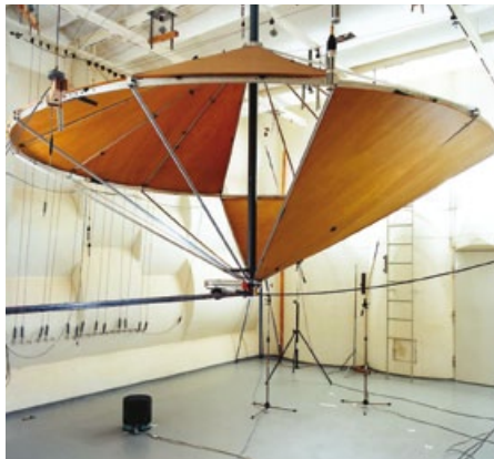
Hallraum der PTB: Der rotierende Schirm sorgt dafür, dass der Schall einer Geräuschquelle möglichst gleichmäßig im Raum verteilt wird.
