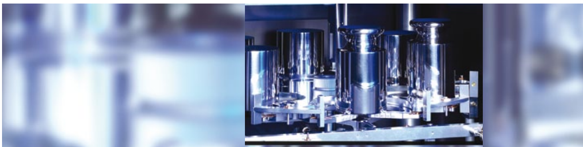
Blick in die Prototypwaage, mit der 1-kg-Massenormale an den nationalen Kilogramm-Prototypen angeschlossen werden können.
