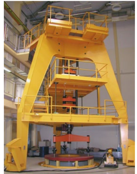
Die größte Kraftmesseinrichtung der PTB, die mit direkter Massewirkung arbeitet: die 2-MN-Normalmesseinrichtung.
