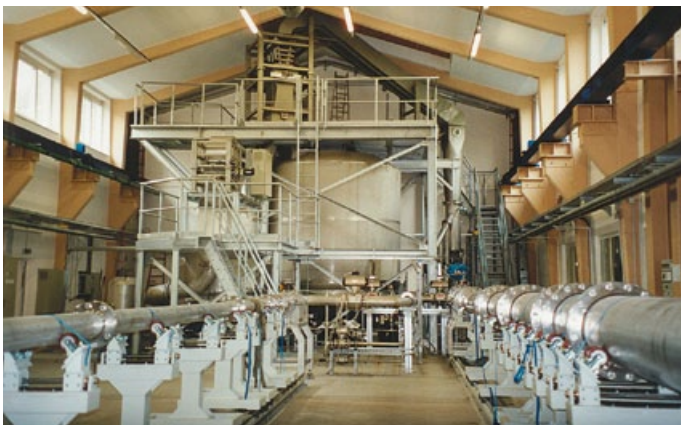
Messstrecken und Wägesysteme des Hydrodynamischen Prüffelds.
