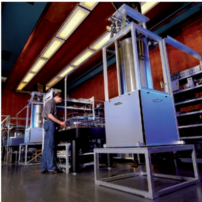
Prominente Aushängeschilder: die Atomuhren (hier die beiden Fontänenuhren) der PTB. Keine andere physikalische Größe lässt sich so präzise messen wie die Zeit.
