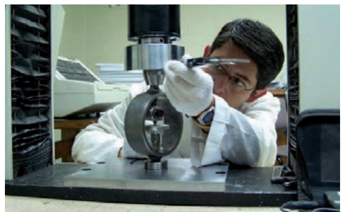
Kalibrierung eines Kraftaufnehmers in Chile
