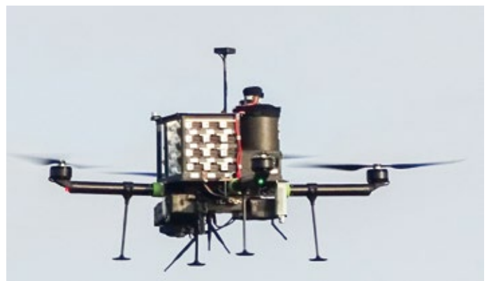
Der Quadcopter ALICE nimmt Luftproben, die dann im Labor weiter analysiert werden können. Zusätzlich misst er Temperatur- und Feuchteprofile bis in 1000 m Höhe. (Foto: Astrid Lampert, TU Braunschweig)
