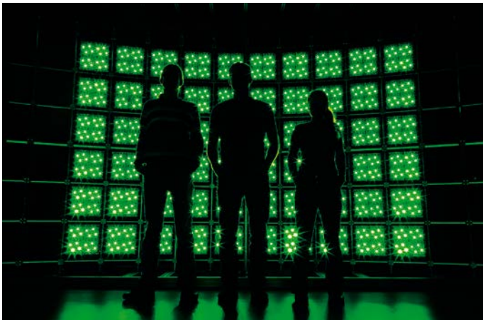
Der LED-basierte Sonnensimulator ist mit 16 320 Hochleistungs-LEDs bestückt, die in 18 verschiedenen individuell ansteuerbaren Farben zur Verfügung stehen.
