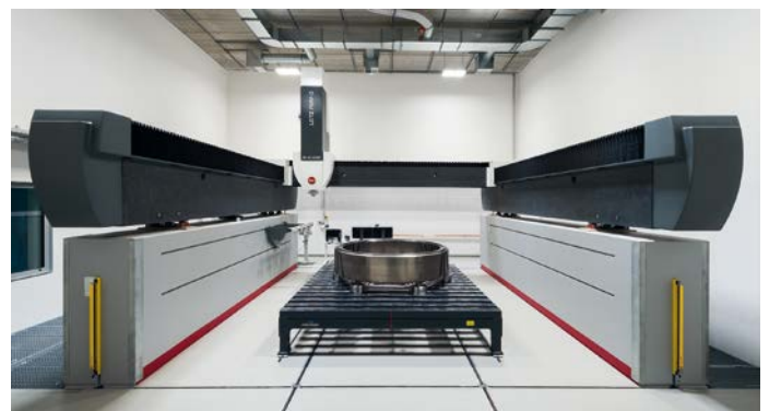
Das Großkoordinatenmessgerät ermöglicht erstmals die metrologische Rückführung von Großbauteilen (5 m × 4 m × 2 m Messvolumen).
