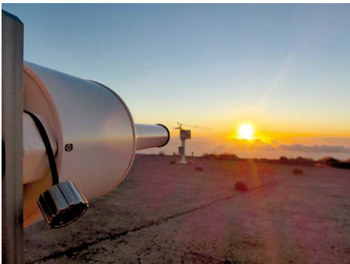
Ein an der PTB charakterisiertes Array-Spektralradiometer blickt auf die aufgehende Sonne am Atmosphärischen Observatorium Izaña auf Teneriffa während einer internationalen Vergleichsmesskampagne zur Bestimmung der Ozonsäule.
