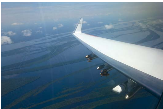
Das Forschungsflugzeug HALO des DLR über dem Regenwald. Mit an Bord: das hochgenaue Feuchtemessgerät HAI aus der PTB, das speziell für den Einsatz in Flugzeugen und in Wolken entwickelt worden ist.
