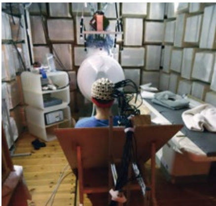
Messvorrichtung zur schnellen Überprüfung von SQUIDs und MEG
