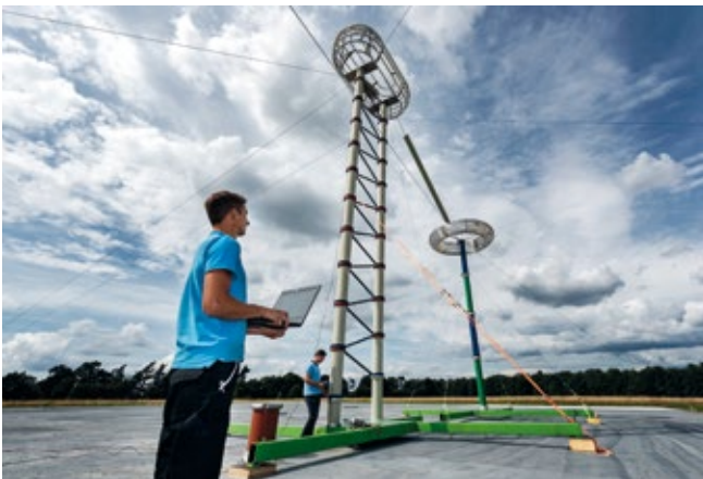
Die Hochspannungsmessanlage der PTB
