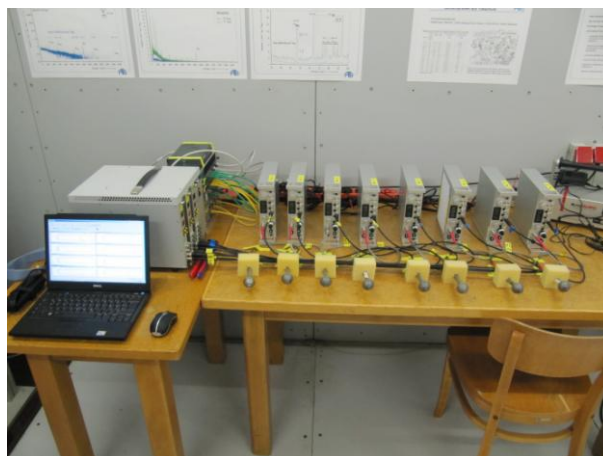
Abb. 1: Versuchsaufbau mit acht parallel betriebenen ^3\text{He} Proportionalzählern. Auf dem Tisch links sind hinter dem Laptop mit der Datenaufnahme-Software weitere Datenaufnahme-Module zu erkennen.
